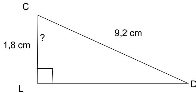
Dans le triangle LCD rectangle en L, on cherche une relation entre l'angle aigu  $\widehat{LCD}$  son coté adjacent et l'hypoténuse du triangle.
